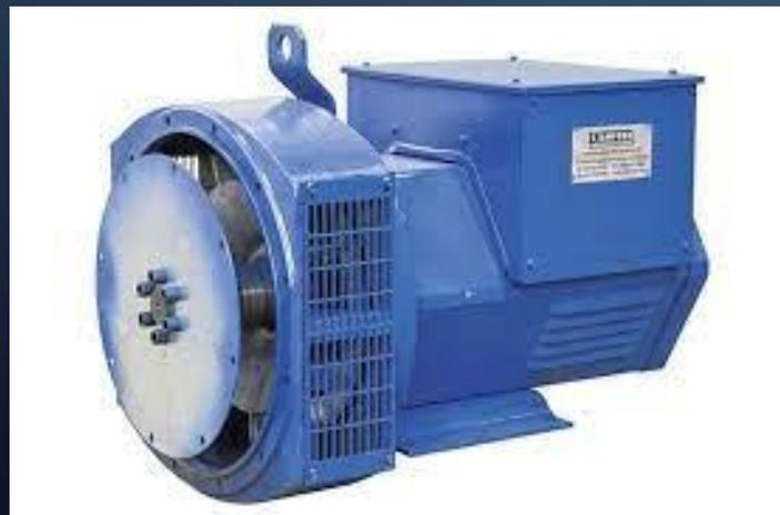
La tensione trifase è in genere realizzata con una macchina elettrica chiamata alternatore trifase, nella quale un campo magnetico induttore meccanicamente rotante, ottenuto con degli avvolgimenti rotanti alimentati con corrente continua, induce, su tre avvolgimenti indotti fissi, disposti tra loro a  $120^\circ$ , una terna di tensioni uguali sfasate di  $120^\circ$
